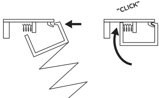
**3** **DK/NO/SE:** Montering af sikkerhedsanordninger **EN:** Installation of Child Safe device
